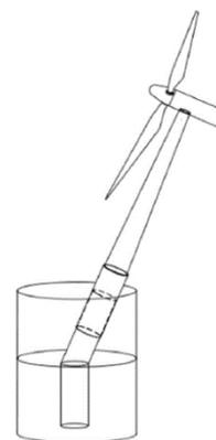
**Ilustración 1:** Fallo por plastificación del pilote. Adaptado de: (Laszlo Arany, 2017)
