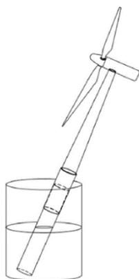
**Ilustración 2:** Fallo por exceder el límite último de la cimentación. Adaptado de: (Laszlo Arany, 2017)
