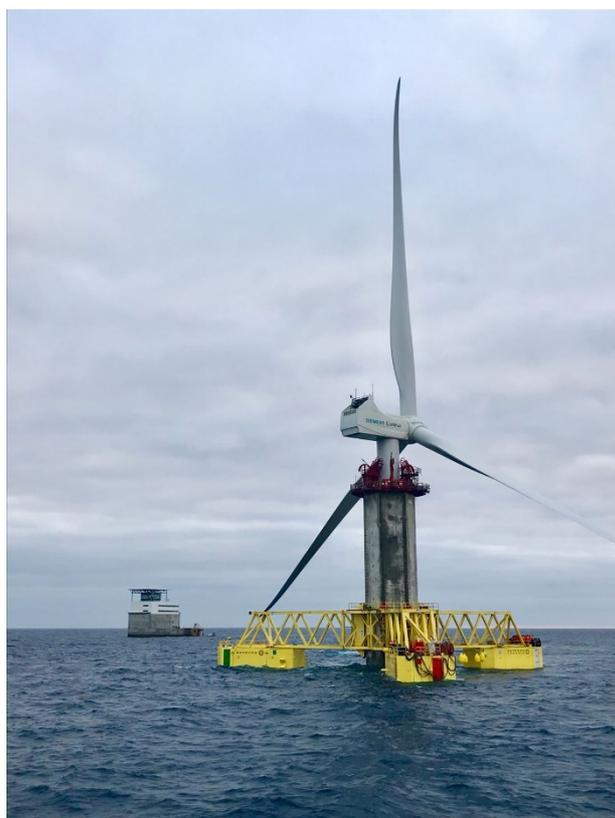
**Ilustración 35:** Prototipo de aerogenerador marino del proyecto Elisa - Elican. Fuente: (Prototipo de aerogenerador marino del proyecto Elican liderado por Esteyco inicia fondeo en el Banco de Ensayos de PLOCAN, 2018)
