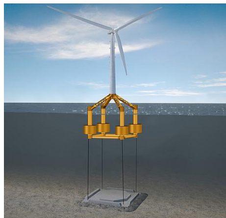
Figura 5. Cimentación Flotante (Obtenida de [23]).
