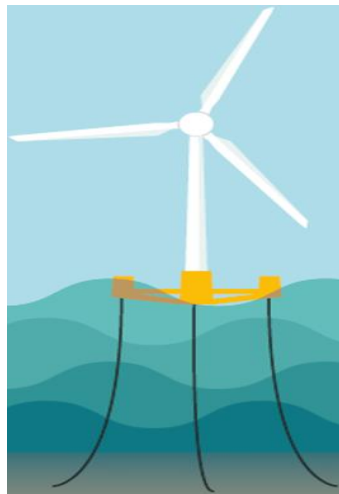
Figura 10. Cimentación flotante semi-sumergible. Fuente: [3].
