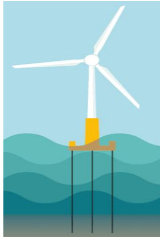
Figura 9. Cimentación flotante TLP. Fuente: [3].
