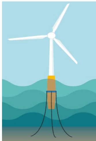
Figura 8. Cimentación flotante tipo Spar. Fuente: [3].
