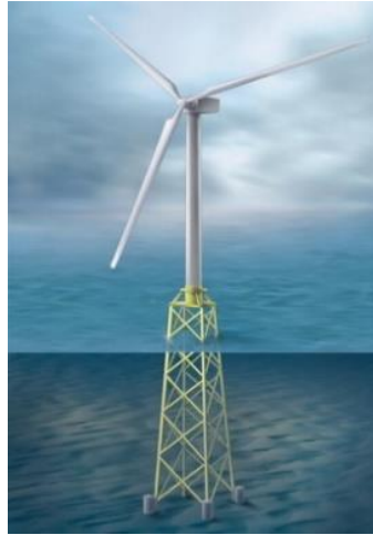
Figura 4. Aerogenerador sobre estructura tipo Jacket. Fuente: [8].
