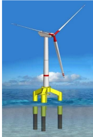
Figura 7. Aerogenerador sobre estructura tripilote. Fuente: [13].
